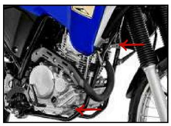
01 - Observe os pontos de fixação do produto na moto, retire o parafuso da furação frontal do motor, Fig. 01 e 02;
