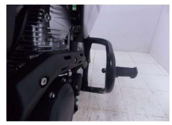
05 - Instale as pedaleiras especiais, Fig. 07 e 08 ;
