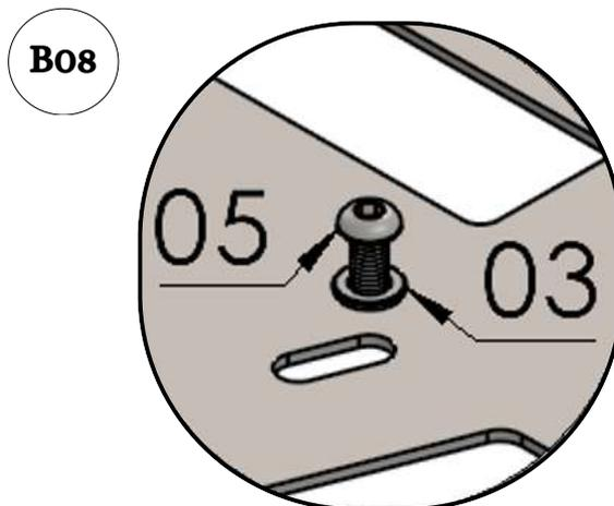
**03 - Para fixação da peça, utilize parafuso cab. abaulada ALLEN MA 06 - 1,00 X 12 INOX rosca total e arruela lisa M6 INOX, Fig. B07 e B08;**
