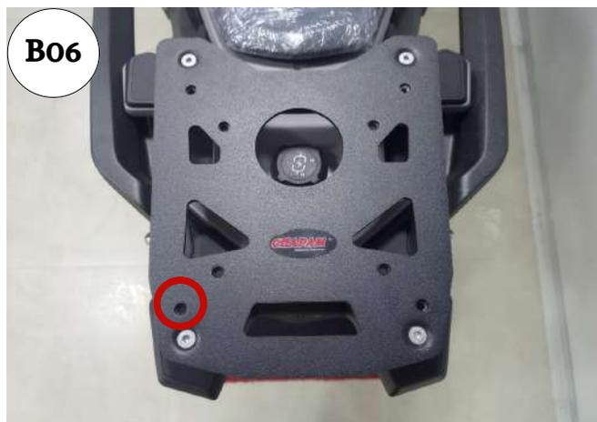
03 - Para montagem vertical, identifique os pontos de fixação, Fig. B05 e B06;
