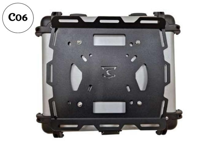
02 - Realize a fixação da grelha universal no bauleto, na parte superior utilize parafuso cab. abaulada ALLEN MA 06 - 1,00 X 25 INOX (rosca total), arruela lisa M6 INOX, a grelha, espaçador Ø Ext. 14,10 x Ø Int. 8,30 x comp. 12,00;
