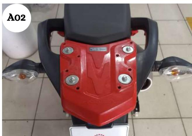
01 - Inicie removendo o emborrachado da rabeta, liberando acesso aos parafusos, Fig. A01 e A02;
