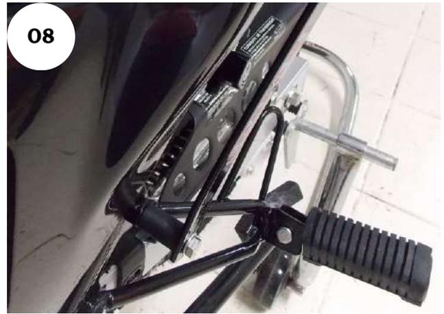
05 - A fixação da parte frontal será no suporte de pedaleiras, adicione um espaçador Ø Ext. 14,10 x Ø Int. 8,30 x Comp. 32,00, arruela lisa M8 (8,40 x 17,00 x 1,50 mm) ZB e parafuso sextavado MA 08 - 1,25 X 60 AÇO 8.8 RP ZB rosca parcial, Fig. 07 e 08;
