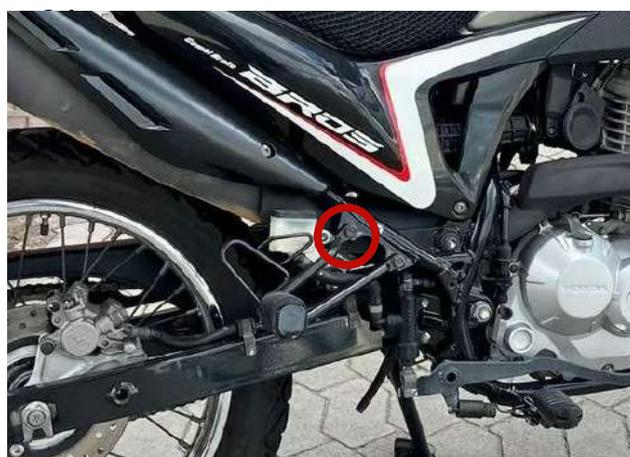
**02-Realize a pré-montagem do suporte de baú, unindo as duas parte em um só pela furação destacada, utilize paraf. sextavado MA 08 - 1,25 X 20 AÇO 8.8 RI ZB (rosca total) e porca sextavada travante baixa M 8 X 1,25 ZB , Fig. 03;**
