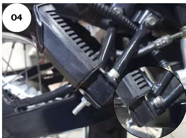
**02 - Substitua os pinos da pedaleira do passageiro pelo conjunto composto por arruela M6, parafusos cab. cilíndrica M6X50 e porca sextavada M6. Dê o aperto ao conjunto, de modo que a pedaleira do passageiro trabalhe normalmente;**
