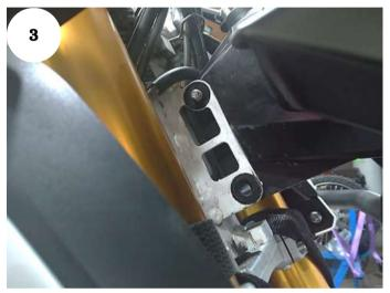
02: Encaixe o suporte de fixação superior (item 05) no parafuso original anteriormente 60, arruela e porca (itens 06, 07 e 08 citado, Fig. 03;
