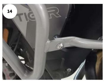
10: Na união com a haste e protetor esquerdo, utilize parafuso M8 x 20, arruelas e porca travante (itens 11, 07 e 08 - Detalhe C), Fig. 14;
