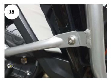
13: Na união com a haste e protetor direito utilize parafuso 08 x 20, arruelas e porca travante (itens 14, 07 e 08 – Detalhe D), Fig. 18;
