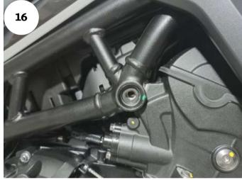
11: Após a lateral esquerda estar montada, deve-se retirar o parafuso da lateral direita do quadro, Fig. 15 e 16;
