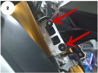
01: Localize os parafusos na parte frontal do quadro, retire as porcas e parafuso inferior (esse será substituído, já o superior permanecerá original), Fig. 01 e 02;
