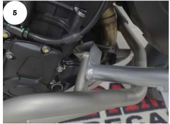
04: Instale o protetor de carenagem esquerdo (item 01). Na fixação com motor, utilize arruela lisa M8 e parafuso M8 x 20 (itens 07, 10 -Detalhe B), Fig. 05;
