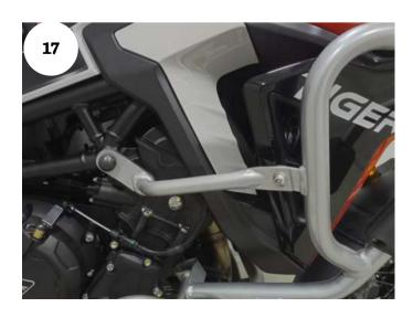
12: Monte a haste lateral direita (item 04) utilizando espaçador de comprimento 13 mm, arruela M10, parafuso M10 x 60 (itens 15, 12 e 13 – Detalhe D). Fig. 17;
