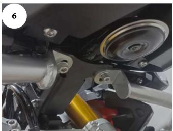
05: Na parte superior faça a união junto ao suporte de fixação inserindo o parafuso M8 x 20 e arruela M8 (itens 09 e 07 - Detalhe A), Fig. 06;
