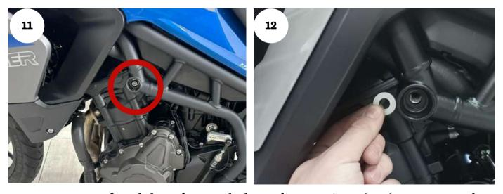
08: Remova o parafuso da lateral esquerda do quadro, atenção, pois existe um espaçador original, ele deverá ser inserido a sua posição original quando for instalada a haste lateral do protetor, Fig. 11 e 12;
