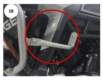
09: Monte a haste lateral esquerda (item 03), inserindo o espaçador de comprimento 19 mm, arruela M10 e parafuso M10 x 60 (itens 11, 12 e 13 – Detalhe C). Fig. 13
