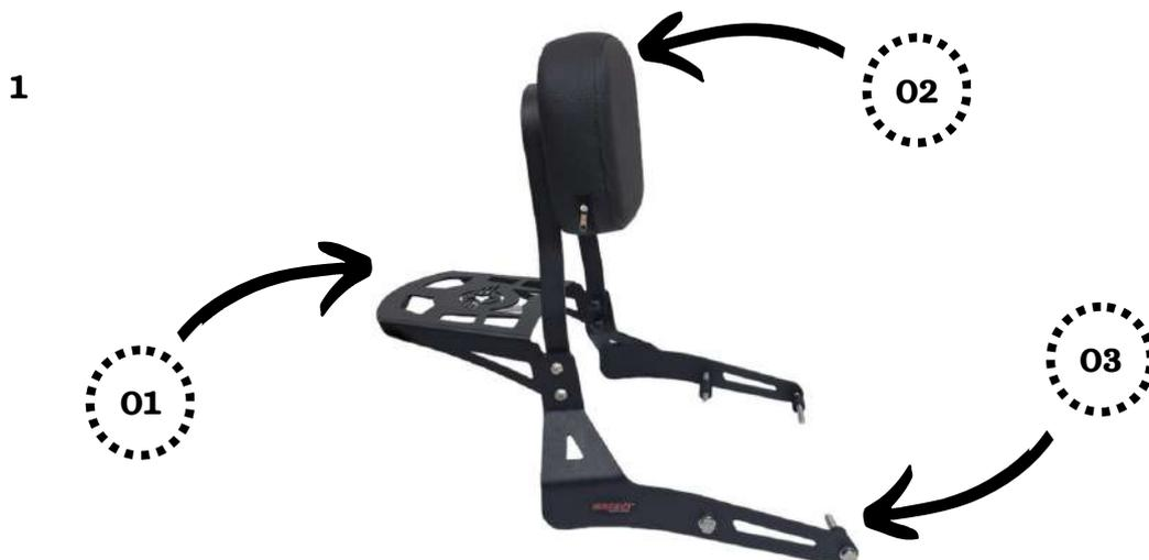
**01- Inicie a montagem do produto realizando a junção do bagageiro(01), da haste(02) e das chapas laterais(03) Fig. 01;**
