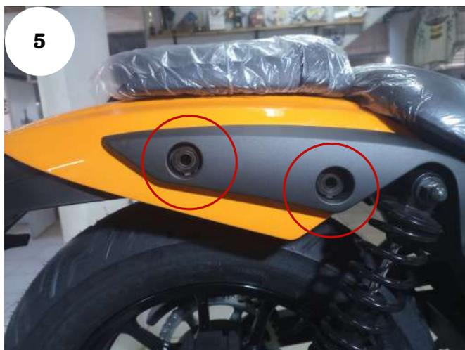
04 - Retire os parafusos das laterais da moto, Fig. 04 e 05;
