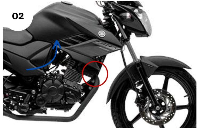
01 - Retire os dois parafusos originais, localizados na parte frontal ao motor, destacado em vermelho na Figura 02;
