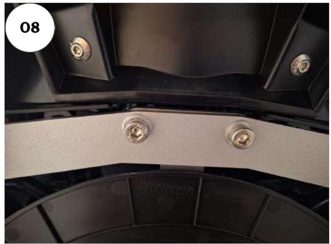
**05 - Faça a instalação da união central do protetor de carenagem BMW junto a chapa anteriormente fixada, utilize paraf. cab. cilíndrica ALLEN MA 08 - 1,25 X 20 INOX (rosca total) e arruela de pressão M8 (8.8), e fixe na porca soldada na capa superior, Fig. 07 e 08;**
