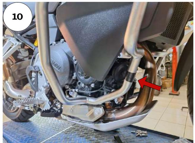
**06 - Realize a selagem do protetor de motor original da moto para não danificar a peça, realize o alinhamento da peça para delimitar o local da selagem, Fig. 09 e 10;**
