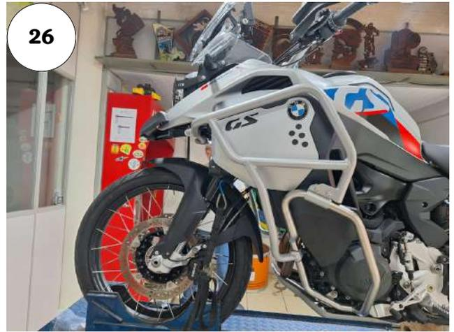
**13 - Confira a posição de alinhamento e realize ajustes se necessários, realize os apertos finais em porcas e parafusos, Fig. 25 e 26;**
