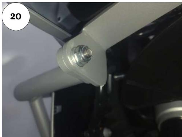
**11 - Faça a fixação do protetor de carenagem com a união central, utilize paraf. cab. abaul. ALLEN MA 08 - 1,25 X 25 INOX (rosca total), arruelas lisas M8 (8,40 x 17,00 x 1,50 mm) e a porca sext. trav. baixa M 8 X 1,25 ZB, Fig. 19 e 20;**
