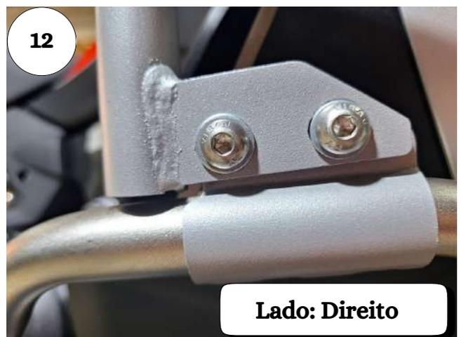
**08 - Alinhe o protetor de carenagem e inicie a fixação pela parte superior do protetor de motor. Adicione a abraçadeira de fixação de tubo redondo conforme lateral correspondente, e parte de fixação do protetor, adicione paraf. cab. abaul. ALLEN MA 08 - 1,25 X 20 INOX (rosca total) e arruela lisa M8 (8,40 x 17,00 x 1,50 mm), Fig. 11 e 12;**
