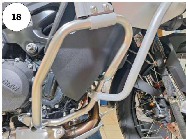
**10 - Realize a fixação na parte inferior do protetor de motor, utilize o paraf. cab. abaulada ALLEN MA 08 -1,25 X 40 INOX (rosca total), a arruela lisa M8 (8,40 x 17,00 x 1,50 mm) e no outro lado da furação utilize a arruela lisa M8 (8,40 x 17,00 x 1,50 mm) e a porca sext. trav. baixa M 8 X 1,25 ZB, Fig. 15, 16, 17 e 18;**
